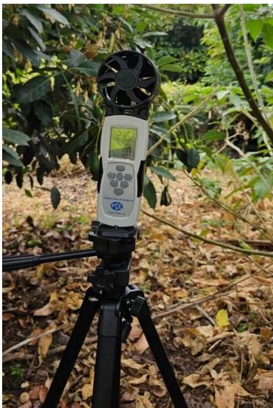
Figura 15. Termohigroanemómetro para toma de datos en el momento de la aplicación de los tratamientos.
