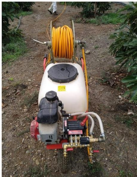
Figura 14. Motobomba hidráulica de gasolina empleada en las aplicaciones.
